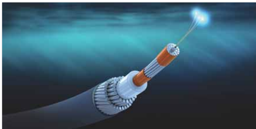
11-сурет. Талшықты-оптикалық кабельдердің қимасы
