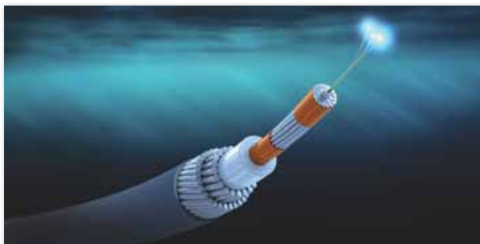
Рис. 11. Опволоконный кабель в разрезе
