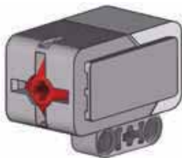
79-сүрәт. Яндишиш датчигидики қизил кнопкениң бесилғини
