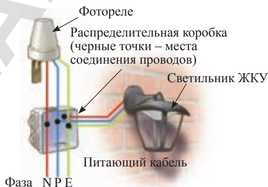
Рис. 230. Схема подключения фоторезистора в цепь уличного освещения
