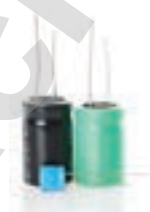
Рис. 187. Металлобумажный и алюминиевый электролитический конденсаторы
