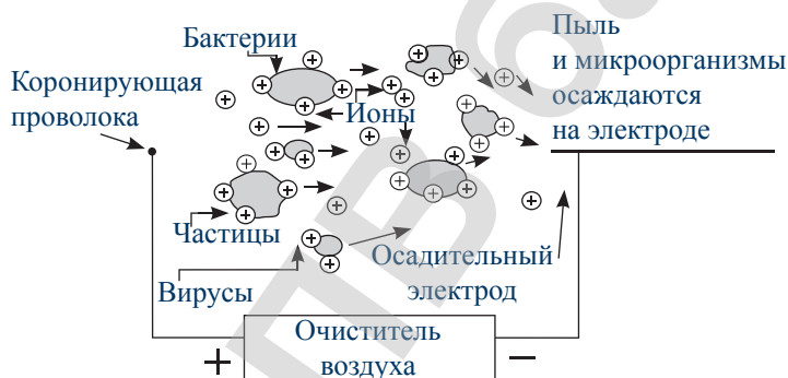
Рис. 253. Электризация пыли под действием коронного разряда
