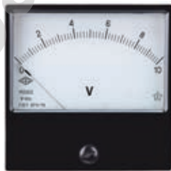
Рис. 4. Шкала вольтметра с классом точности 2
