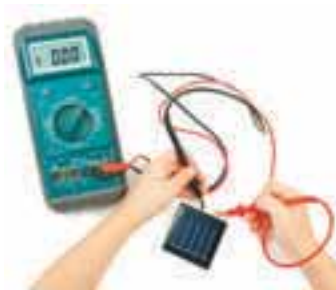
25-сүрәт. Мультиметр ярдими билән турақлиқ ток мәнбәсиниң ЭҺК-ни өлчәш
