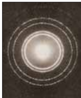
109-сурәт. MgO порошогиниң электронограммиси
