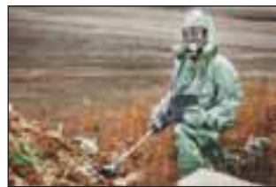
152-сүрәт. Зәхимләнгән йәрликниң радиациялик фонини тәкшүрәш
