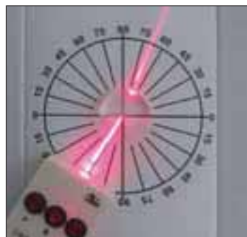
96-сүрәт. Оптикилик диск арқилиқ әйнәкниң сунуш көрсәткүчисини ениқлаш
