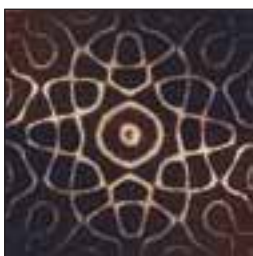
97-сүрәт. Динамика тәвренишлири арқилиқ елинған Хладни нәқишлири
