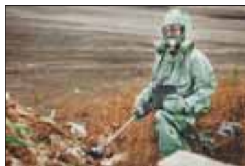
255-сүрәт. Зәхимләнгән йәрликниң радиациялик фонини тәкшүрәш
