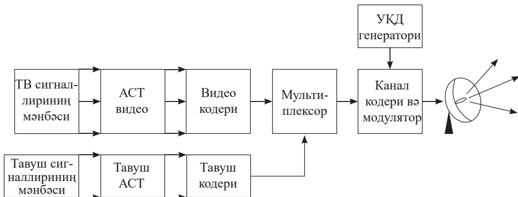
114-сүрәт. Санлиқ таратқучи телевизиялиқ системиниң структурилиқ схемиси
