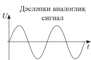
113-сүрәт. Компьютерда ишләш үчүн аналоглиқ сигнални кодлаш
