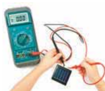
35-сүрәт. Мультиметр ярдими билән турақлиқ ток мәнбәсиниң ЭҒК-ни өлчәш
