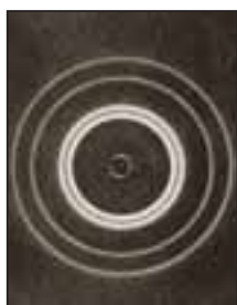
238-сүрәт. а) Рентгенограмма; ә) MgO порошогиниң электронограммиси
