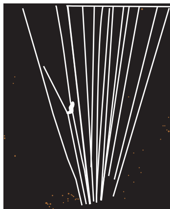
249-сүрәт. Вильсон камерисидики \alpha -зәрриләрниң треклири, \alpha -зәрриләрниң азот атоми билән урулиши, сол тәрәптин иккинчи трек
