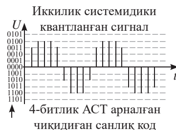
113-сүрәт. Компьютерда ишләш үчүн аналоглиқ сигнални кодлаш
