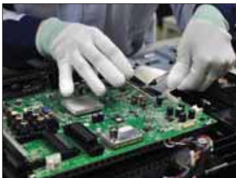
25-сүрәт. Телевизор вә бесиш платиларни жиғиш линияси
