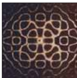
97-сүрәт. Динамика тәвренишлири арқилиқ елинған Хладни нәқишлири
