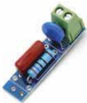
а) RC-тизма – реле контактлирини қорғаиш үчүн
