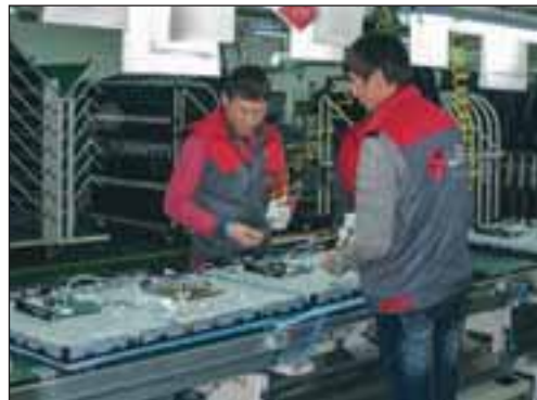
25-сүрәт. Телевизор вә бесиш платиларни жиғиш линияси
