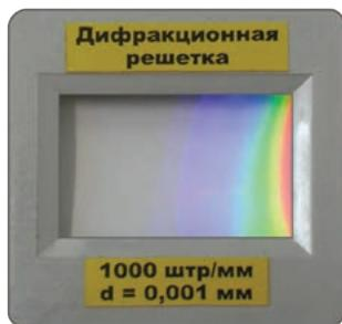
Рис. 80. Прозрачная и отражательная дифракционные решетки
