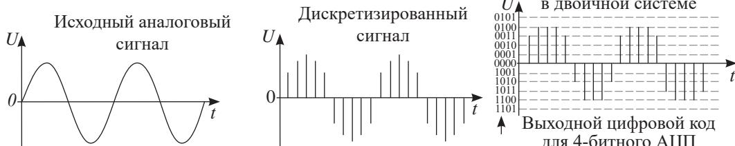
**Рис. 62.** Кодирование аналогового сигнала для компьютерной обработки
