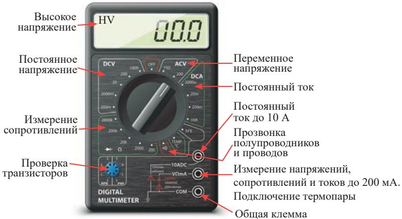
*Рис. 26. Панель мультиметра с указанием режимов работы*
