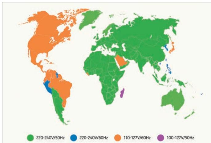
*Рис. 23. Стандарты напряжения и частоты в различных странах*
