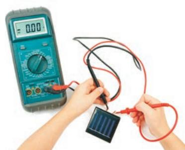
Рис. 25. Измерение ЭДС источника постоянного тока мультиметром
