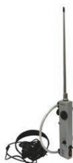
*Рис. 70. Радиопеленгатор диапазона 3,5 МГц.*
