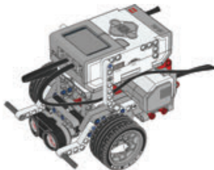
29-сүрәт. Ультратавуш датчиги орунлаштурулған EV3 роботни
