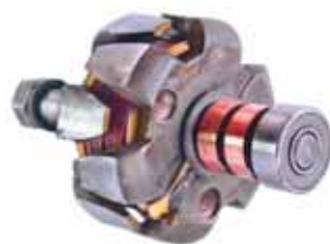
Рис. 171. Внутренняя обмотка генератора – индуктор
