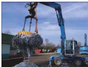
Рис. 154. Подъемный кран с магнитом
