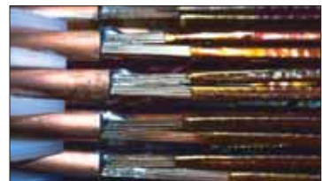
Рис. 123. Сверхпроводящие кабели, разработанные в лаборатории ЦЕРН
