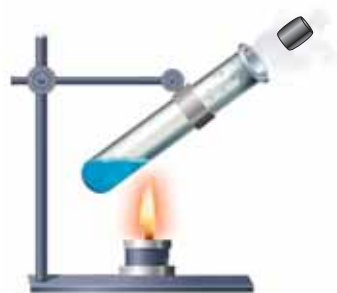
Рис. 8. Уменьшение внутренней энергии пара при совершении работы
