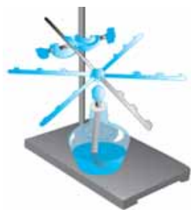
Рис. 9. Различия теплопроводности металлов
