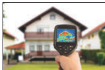
197-сүрәт. Тепловизорни қоллиниш арқилиқ турушлуқ өйниң иссиқлиқ чиқимини тәтқиқ қилиш
