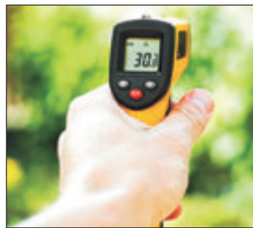
196-сүрәт. Пирометр арқилиқ ялқунниң температурисини ениқлаш t = 30,8^{\circ}\text{C}
