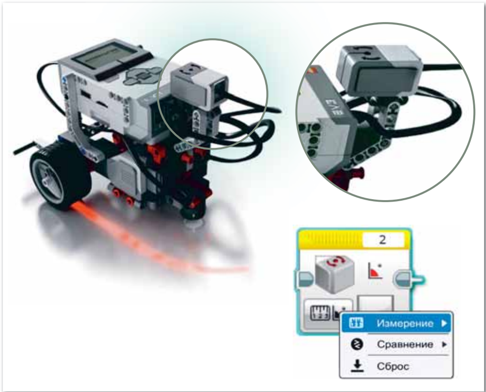
Рис. 53. Расположение и режимы гироскопического датчика
