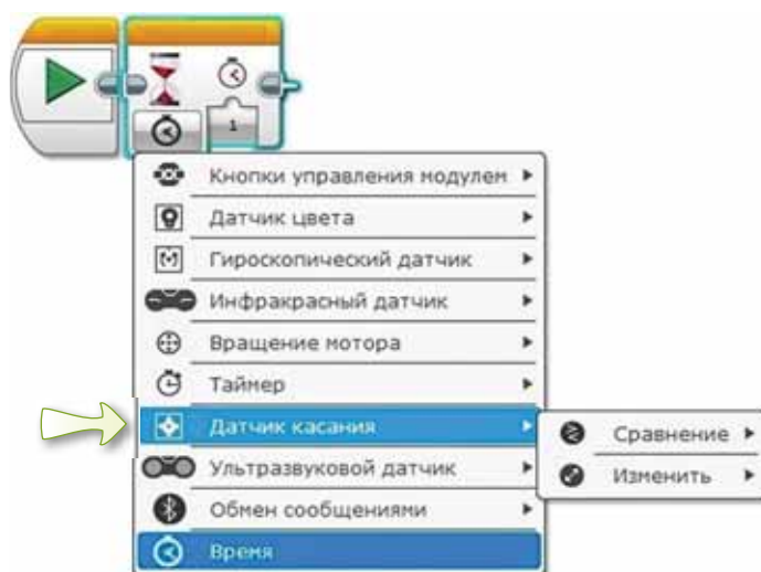
Рис. 81. Режимы датчика касания
