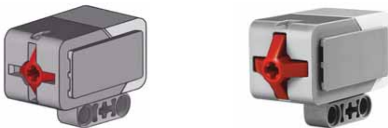
Рис. 79. Датчик касания определяет, нажата ли красная кнопка (слева) или нет (справа)
