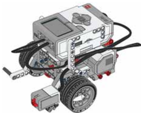
Рис. 80. Приводная платформа с расположенным датчиком касания
