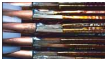
186-сүрәт. CERN лабораториялирида ясалған адәттин ташқири өткүзгүч кабельлар
