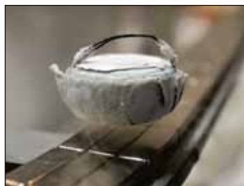
188-сүрәт. Адәттин ташқири өткүзгүчниң турақлик магниттин ясалған рельслар билән һәрикәтлиниши
