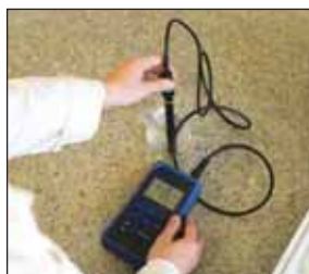
170-сүрәт. Датчиги бар термистор
