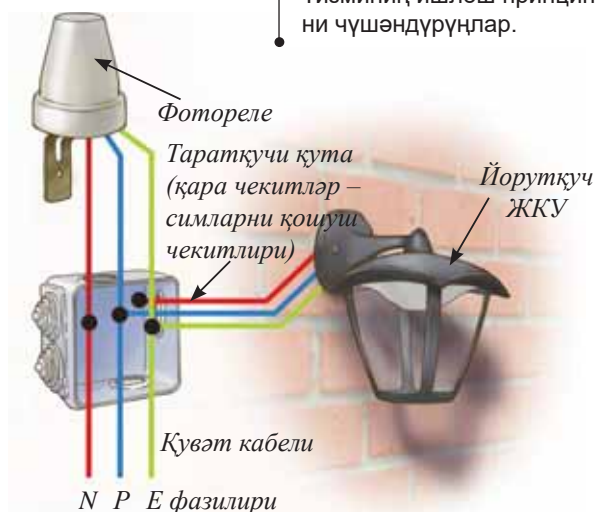
173-сүрәт. Кочини йоруқландуруш үчүн фоторезисторни (фотореле) тизмига қошуш схемиси.
