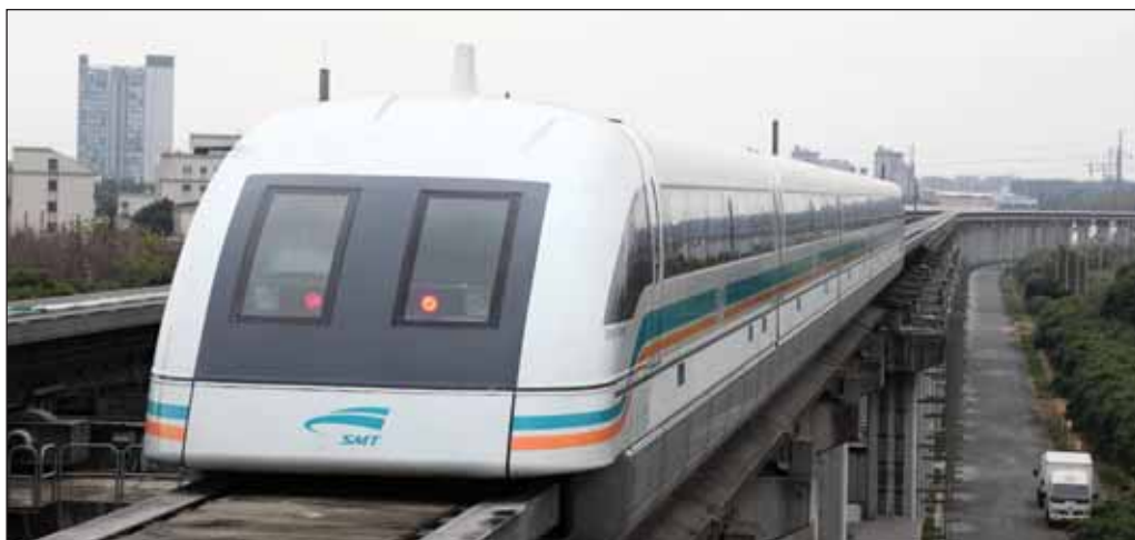
191-сүрәт. Адәттин ташқири өткүзгүч магнитлардики поездлар
