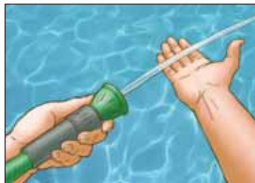
84-сүрәт. Ламинарлик еқим вақтида еқим трубкисиниң қиймисиниң мәйдани сақлиниду
