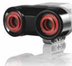
20-сурет. Ультрадыбыс датчигі
