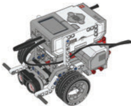
29-расм. Ультратовуш датчиги жойлаштирилган EV3 роботи
